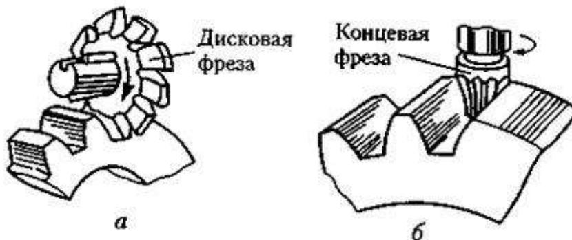
Рис.45. Фрезерование зубьев цилиндрического колеса
