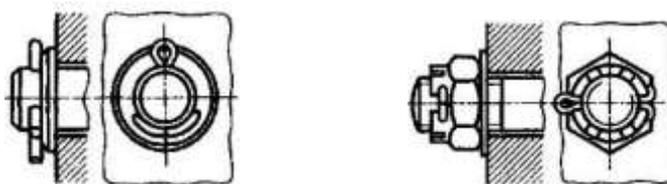
Рис.27. Соединения шплинтом
