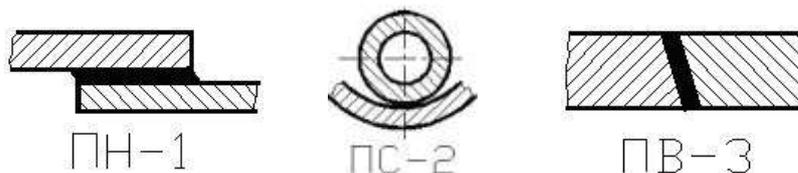
Рис.124. Типы паяных соединений
