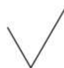
Рис.88. Обозначение без указания способа обработки
