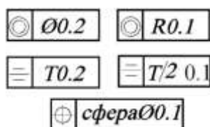
Рис.69. Обозначения допуска с указанием символов
