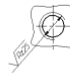
Рис.106. Пример обозначения шероховатости внутренней резьбы
