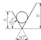
Рис.90. Знак шероховатости без удаления слоя материала
