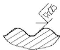
Рис.100. Обозначение шероховатости поверхности профиля резьбы
